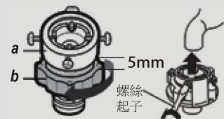
3 用十字螺絲起子略鬆開四個螺絲，以套得進水龍頭為準。再將連接器向上套上水龍頭與水龍頭靠緊後，將螺絲鎖緊，再順時針轉回螺母b部份，使ab密合，水龍頭便與連接器結合一體。
