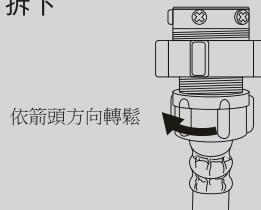
3 用十字螺絲起子略鬆開四個螺絲，以套得進水龍頭為準。再將連接器向上套上水龍頭與水龍頭靠緊後，將螺絲鎖緊，再順時針轉回螺母b部份，使ab密合，水龍頭便與連接器結合一體。
