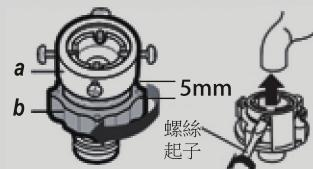
4 將進水管依下列旋緊方向鎖回去。
