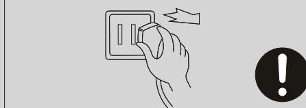
不要使用電源線過分彎曲、過度拉伸、扭轉、捆紮或改造、受重物重壓或夾入；當電源線或電源插頭損壞或插座鬆動時，為避免危險，必須由我公司特約維修點通知售後服務部門專職人員更換。電源插頭的插片要保持清潔，電源插頭上若沾有灰塵，請仔細用乾布擦拭掉。
